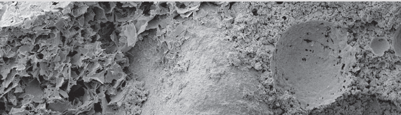
De microporiëncoating verhindert condensvorming en beschermt daardoor tegen algen en mossen
