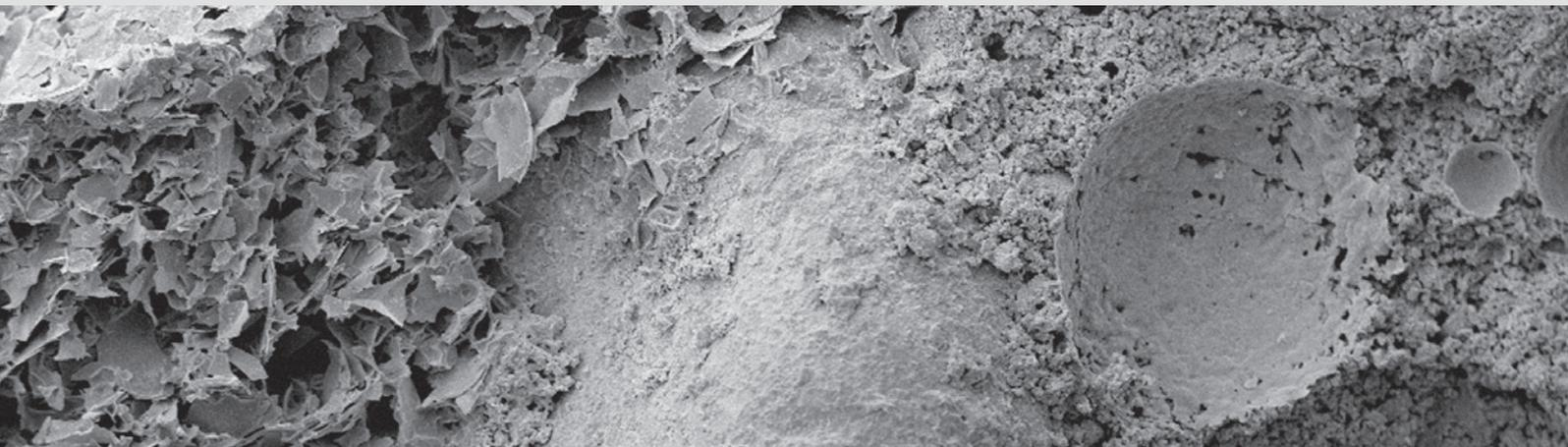
Il rivestimento microporico previene la formazione di condensa, proteggendo dalle alghè e dal muschio
