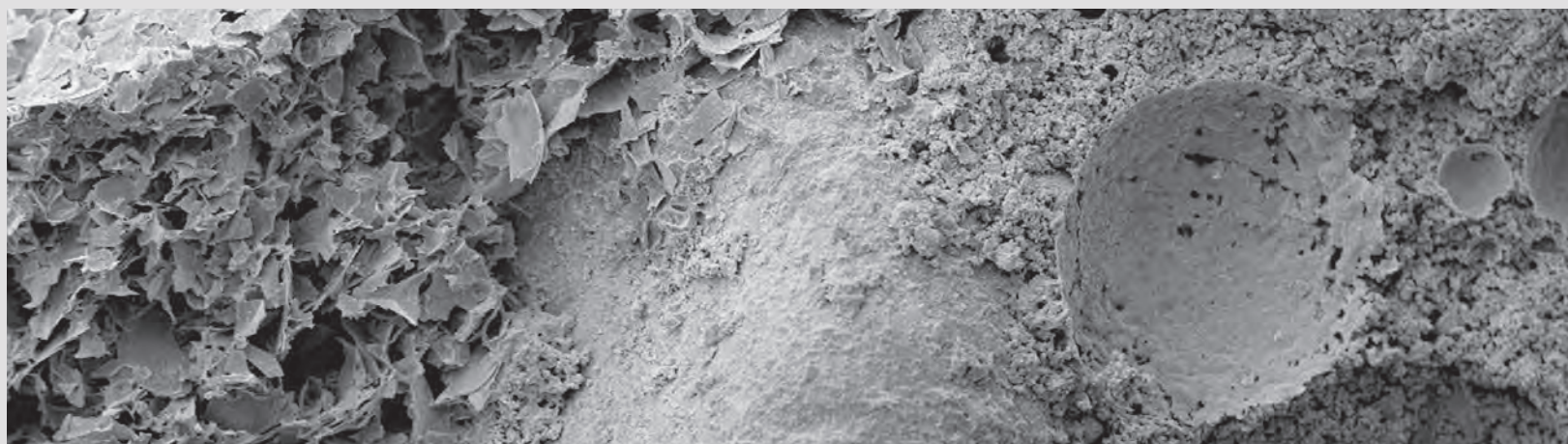
Mikroporer forhindrer kondens optagelse og beskytter mod begroning.
